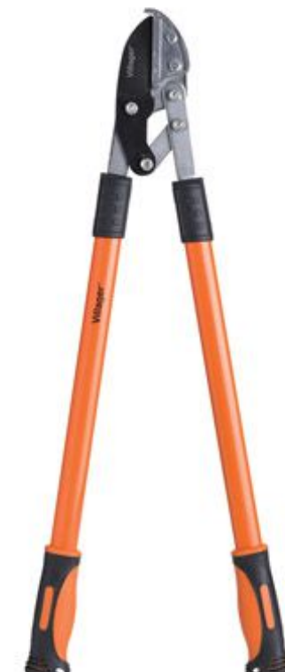
Makaze za grane ravna oštrica LS 108_08016 Materijal sečiva čelik: 65 Mn čelik Dužina makaza- 740 mm Dužina sečenja- 70 mm Prečnik sečenja: Ø 30 mm
