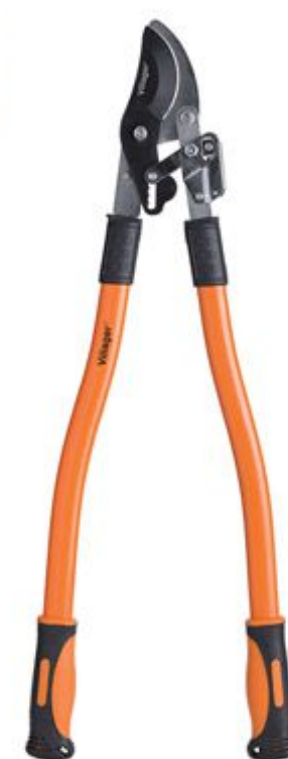
Makaze za grane zakrivljena oštrica - kriva drška SL 113_11279 Materijal sečiva: 50 # čelik Dužina makaza: 750 mm Dužina sečiva: 100 mm Prečnik sečenja: Ø 30 mm
