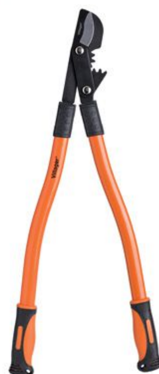
Makaze za grane zakrivljena oštrica - zupčasti prenos kriva drška LS 114_11276 Materijal sečiva: 65 Mn čelik Dužina makaza: 720 mm Dužina sečiva: 90 mm Prečnik sečenja: Ø 25 mm
