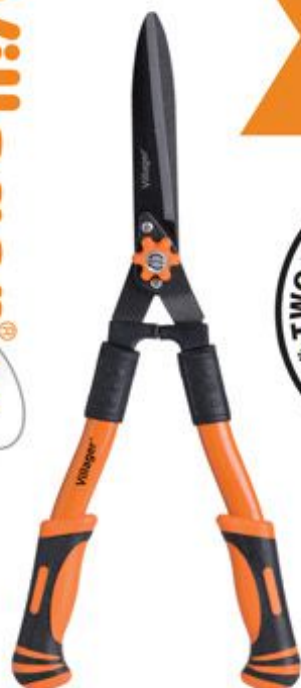
Makaze za živu ogradu ravna oštrica HS 115_23313 Materijal sečiva: 65 Mn čelik Dužina makaza: 650 mm Dužina sečenja: 25,6 mm Prečnik sečenja: Ø 5 mm
